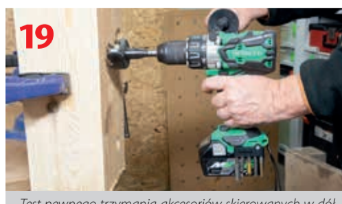
Test pewnego trzymania akcesoriów skierowanych w dół podczas wiercenia dużych otworów w drewnie
