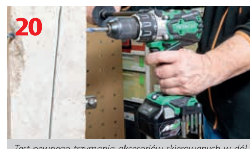
Test pewnego trzymania akcesoriów skierowanych w dół podczas wiercenia udarowego w betonie
