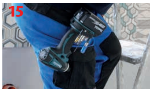
Test przenoszenia akcesoriów umieszczonych w dół w magazynkach BITMAG
