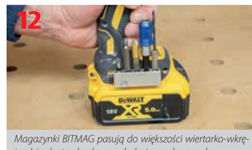
Akcesoria możemy wyjmować i wkładać do magazynków BITMAG w grubych rękawiczkach
